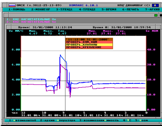
Рис. 24. Тренды V_{rms} и S_{rms} отражают процесс виброналадки по параметрам вибрации
